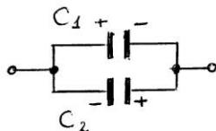
Т.к. обкладки конденсаторов соединены разноименными полюсами, то для общего заряда такой схемы можно записать:  $\pm q_{\text{общ.}} = q_1 - q_2$ . Это значит, что общая полярность обкладок конденсаторов зависит от того, какой заряд больше по модулю. Таким образом, можно
